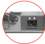
Sensor fotoeléctrico para evitar vuelco lateral
