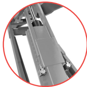
Dispositivo de desbloqueo neumático con bloqueo mecánico
